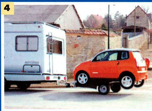
4-6. Буксировочное устройство для транспортировки легковых автомобилей Р. Биссона (позади автофургона) после освобождения от автомобиля приводится на стоянке в вертикальное положение.
