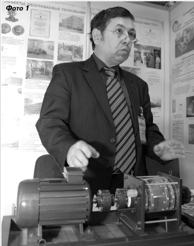
кальный. Тем не менее установлено, что за один проход сквозь теплогенератор температура повышается на 14—24 градуса. А поскольку в замкнутой системе проходов несколько (прокачивается до 3 т/ч), воду можно нагреть до 95°. Горячая вода направляется в системы водо- и теплоснабжения. В последней поступает в теплообменники, где нагрева-
