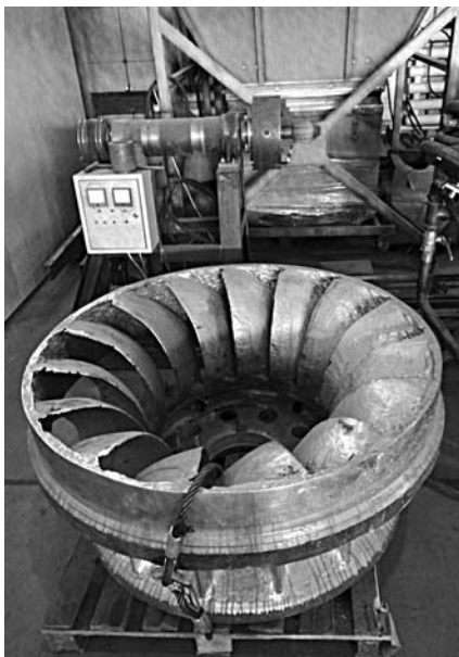
Рабочее колесо гидротурбины после эксплуатации.
