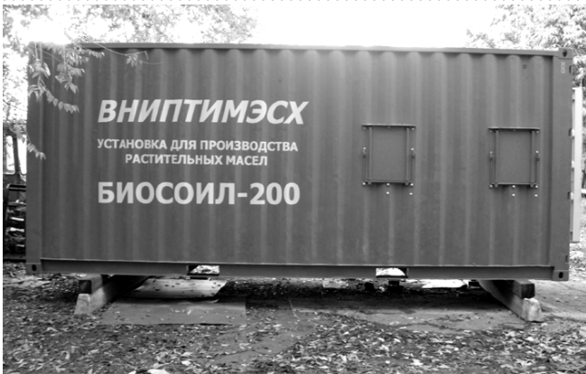
Модульная установка для холодного отжима семян масличных культур «БИОСОИЛ-200» производительностью до 700 л в сутки.
