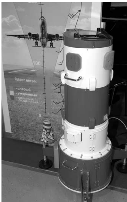
Фото 2. Лидарный комплекс анализирует метеопараметры атмосферы, характер и опасность ее загрязнения.
