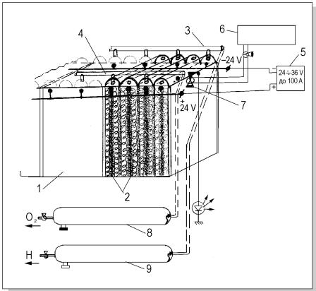
1) корпус аккумулятора 6СТ-60, 2) пластины УВС, 3) газовый коллектор водорода, 4) газовый коллектор кислорода, 5) источник постоянного тока, 6) бак водного раствора КОН на 10 л, 7) поплавок с клапаном уровня жидкости, 8) ресивер кислорода на 10 л, 9) ресивер водорода на 15 л.
