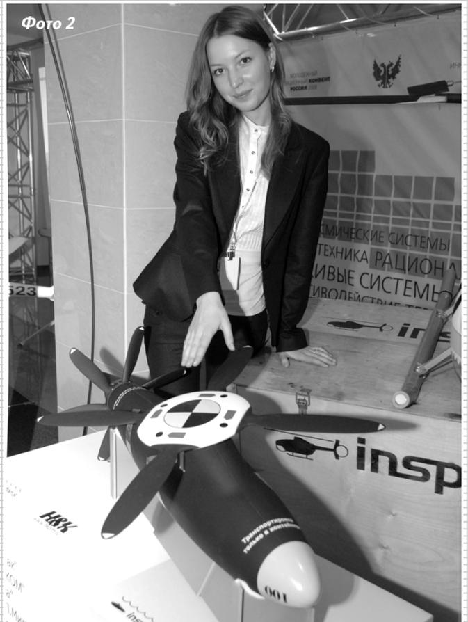
пенсирующие реактивный момент от маршевого двигателя и позволяющие управлять этим необитаемым подводным аппаратом (НПА). То есть эти лопасти используются как плавники. Изменив их углы установки, мы можем поднять или опустить лодку, наклонить ее на нужный борт, благодаря чему она совершает вираж и поворачивает направо или налево.
