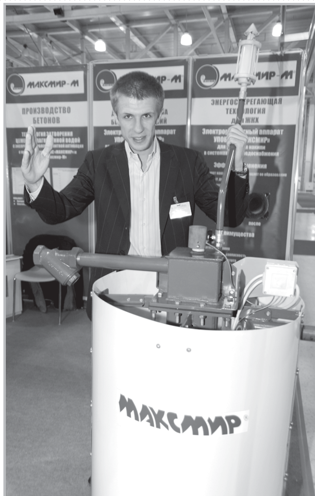
Аппарат, обрабатывающий воду различными полями и ультрафиолетом, компактен, неприхотлив и прост.
