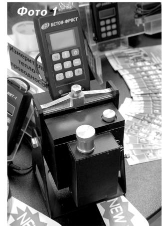
ности и другие, по показаниям которых выстраивается корреляционная кривая. Она позволяет оценить качество дороги перед нанесением покрытия, а также точно определить плотность и степень уплотнения дорожного покрытия, установить наиболее эффективные траектории укатки асфальта, выявить недоуплотненные участки, контролировать критические зоны (стыки, кромки, траектории колес). Это ведет иной раз к сокращению количества проходов катка по уложенной массе ас-
