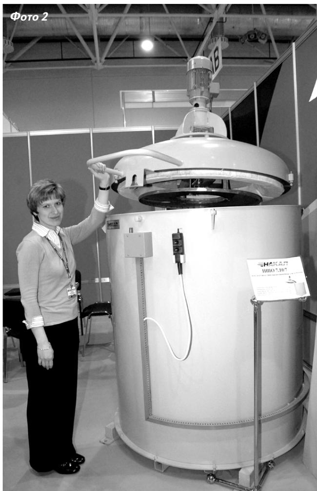
установлена специальная система управления, позволяющая контролировать углеродный потенциал, т.е. количество углерода в этой атмосфере (ноу-хау). Оно устанавливается в зависимости от требуемого качества и состава поверхности цементируемого изделия. Это, во-первых, заметно повышает качество получаемых изделий (их поверхность насыщается в точности на ту глубину и так, как требуется именно для этого изделия), а во-вторых,
