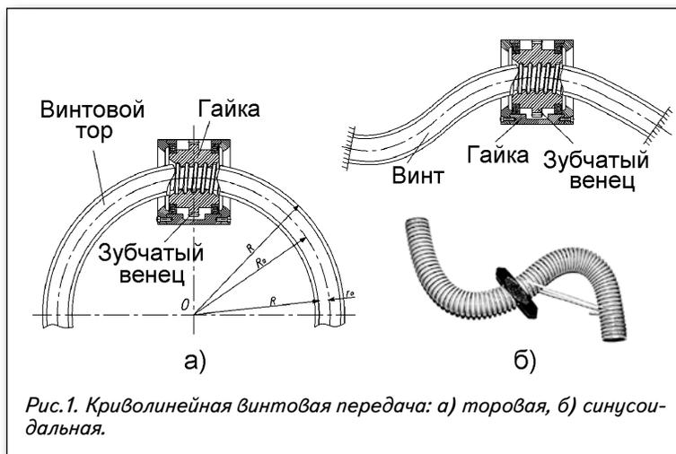
Рис.1. Криволинейная винтовая передача: а) торовая, б) синусоидальная.
