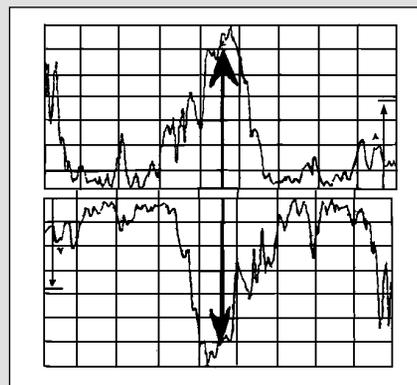
Рис.2. Режим стоячей волны УЗ-колебаний.
