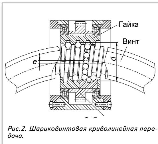
Рис.2. Шариковинтовая криволинейная передача.
