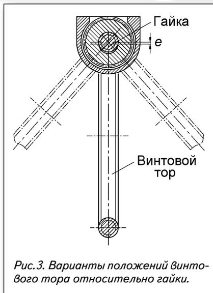
Рис.3. Варианты положений винтового тора относительно гайки.
