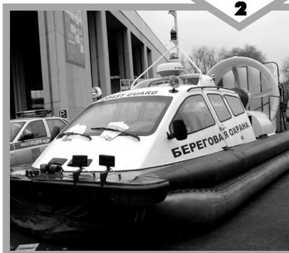
но отключившегося двигателя прекращается нагнетание воздуха под «юбку», и судно может сильно удариться корпусом о воду. Даже при небольшом волнении это грозит подтоплением. А если оно несется над ледяными торосами или острыми камнями, то они тем более могут повредить корпус.
