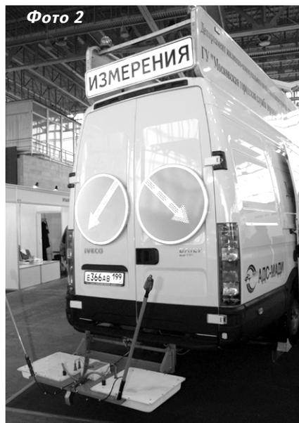
в бортовой компьютер, на экране монитора которого постоянно рисуется кривая, характеризующая продольный профиль дороги. Он пересчитывает эти данные на показатели «продольной ровности», сопоставляя их с соответствующими нормативами.
