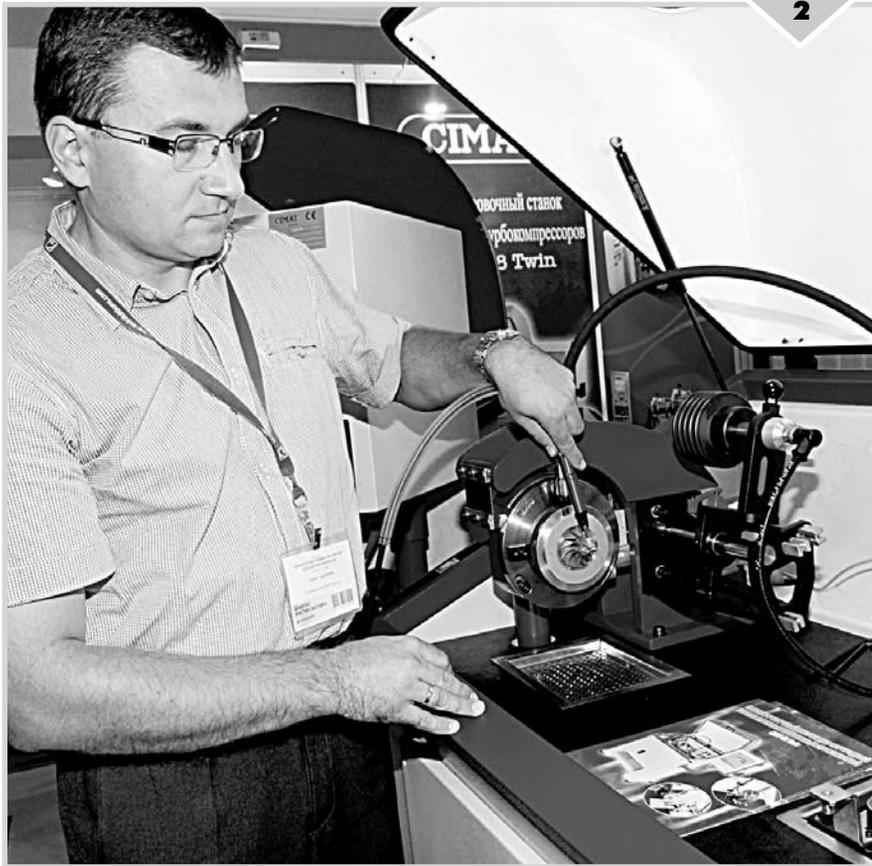
Балансировка ротора турбокомпрессора.
